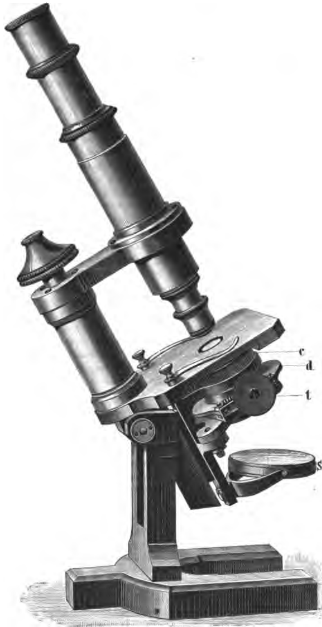
Fig. 6. Stativ Va von ZEISS in \frac{2}{3} natürl. Grösse, zum Umlegen, doch ohne drehbaren Oberkörper; mit ABBE 'schem Beleuchtungsapparate, c Condensor, d Diaphragmenträger, t Trieb an demselben, s Doppelspiegel.
